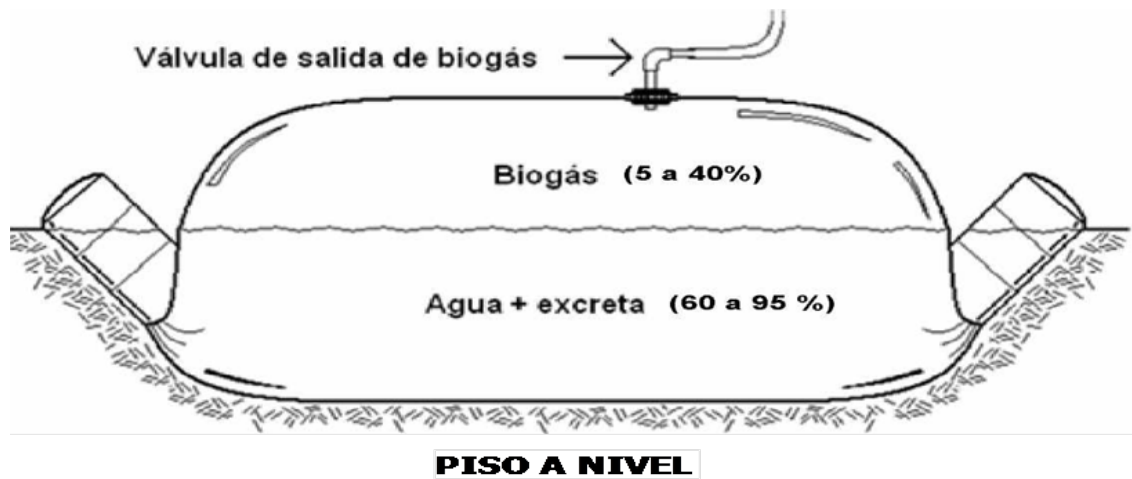
Figura 8. Ejemplo de biodigestor modelo Taiwán.
