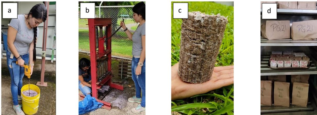
**Figura 2.** (a) Mezcla de materiales según las proporciones por tratamiento, (b) Prensado del material, (c) Biocombustible sólida fabricada y (d) Biocombustible sólido en el horno a 65°C.
