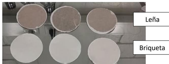
**Figura 5.** Comparación de filtros utilizados en la prueba de Material particulado de leña contra la briqueta, en la que se observa mejoras utilizando la briqueta.
