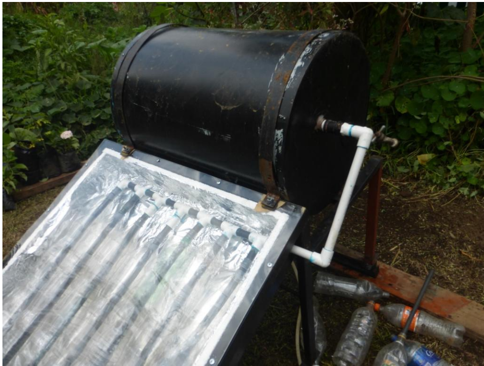
Figura 17. Calentador solar de agua de entusiasta anónimo.
