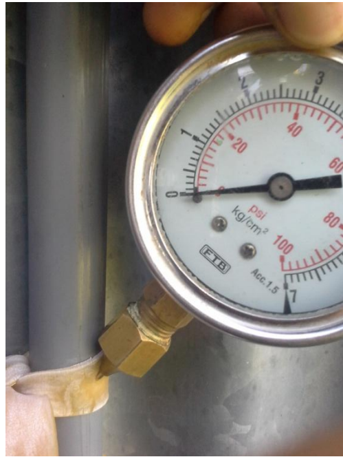
Figura 21. Medición de presión con un manómetro en punto de inyección de nutrientes.
