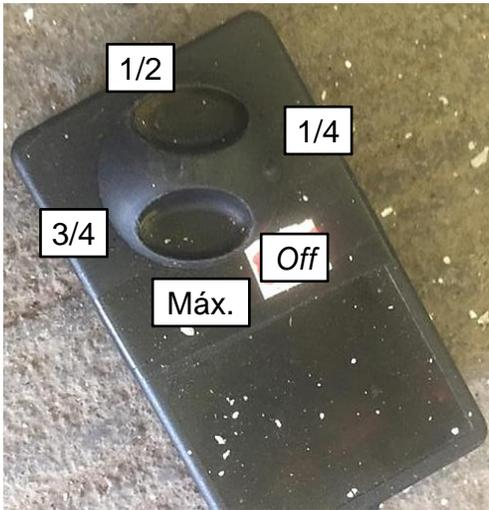
**Figura 8.** Regulador de velocidad del ventilador.
