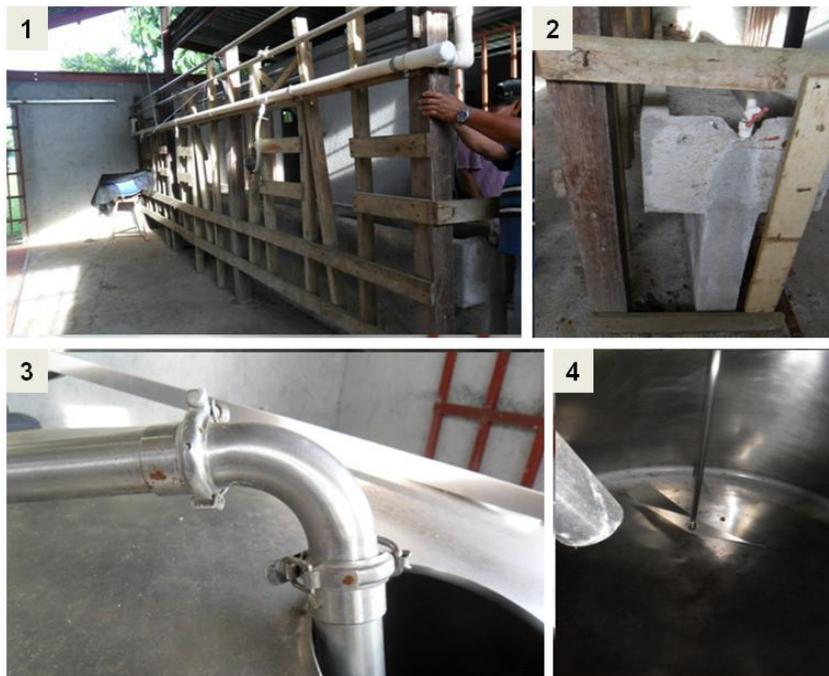
**Figura 8.** Infraestructura de la sala de ordeño: 1) inadecuados puntos de unión para el soporte del ganado al momento del ordeño, 2) excesiva altura de los comederos, 3) maquinaria con principios de oxidación y deterioro, 4) implemento de la maquina inadecuado.
